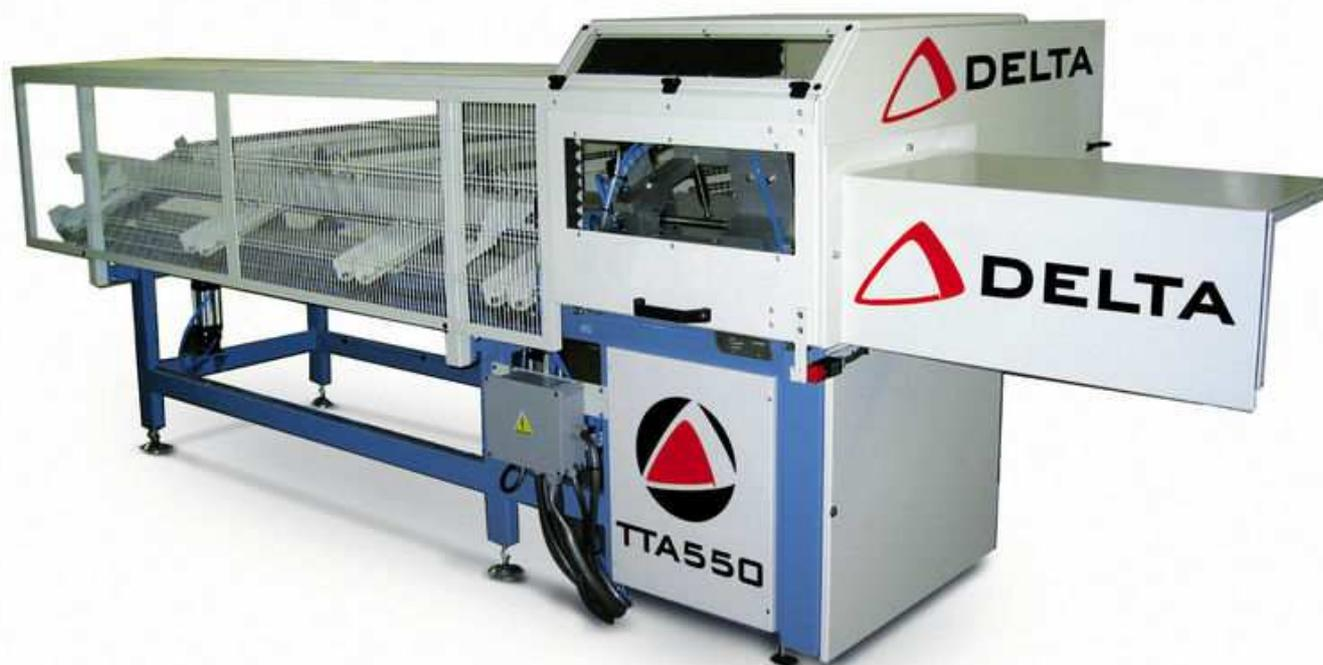
Cette machine automatisée permet la fabrication de palette de manutention. Elle est automatisée par l'intermédiaire d'un automate TSX 37.
