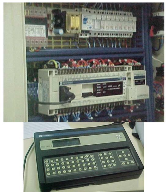
**Objectif :** Etre capable de transférer un programme contenu dans la RAM d'un TSX 17/20 vers une cartouche EEPROM à l'aide d'une console de programmation TSX T407
