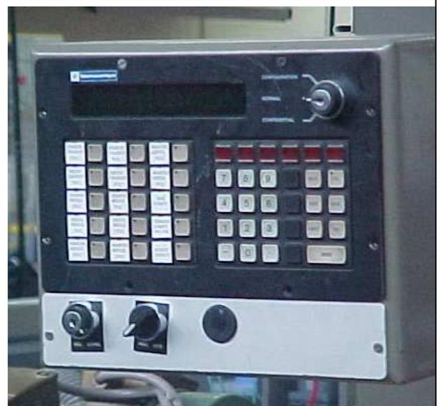
**Objectif :** Etre capable de réaliser un bouchon de test et d'effectuer le test d'un terminal d'exploitation "XBT".
